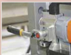
Alimentación a través de la palanca de llave de trinquete. Cambiable de uso en el lado izquierdo y derecho.
