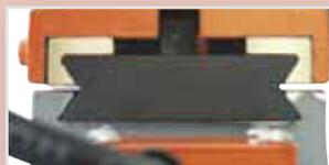
¿Problemas con las guías simples de cola de milano o columnas redondeadas? Las guías de latón estables garantizan una guía del carro óptima.
