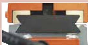
¿Problemas con las guías simples de cola de milano o columnas redondeadas? Las guías de latón estables garantizan una guía del carro óptima.
