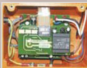
¿El centro de nuestras máquinas de taladros magnéticos? Conmutadores electrónicos robustos, intercambiables entre los Modelos 32-40-60-100 y entre 40 RL-E-60 RL-E-100 RL-E.
