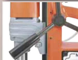
Motor de elevación ajustable en altura para una mayor sección de carrera en el empleo con brocas espirales, portabrocas o en el roscado. Los contrarroles de latón sólido garantizan un óptimo deslizamiento.
